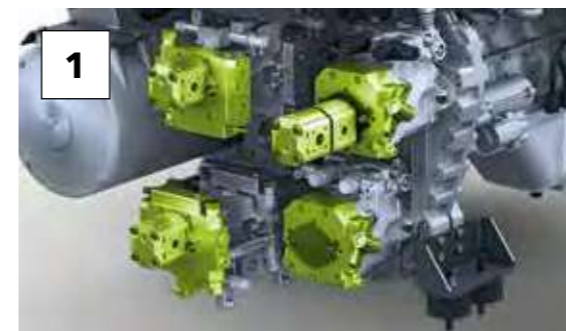
Отключаемый редуктор насосов
