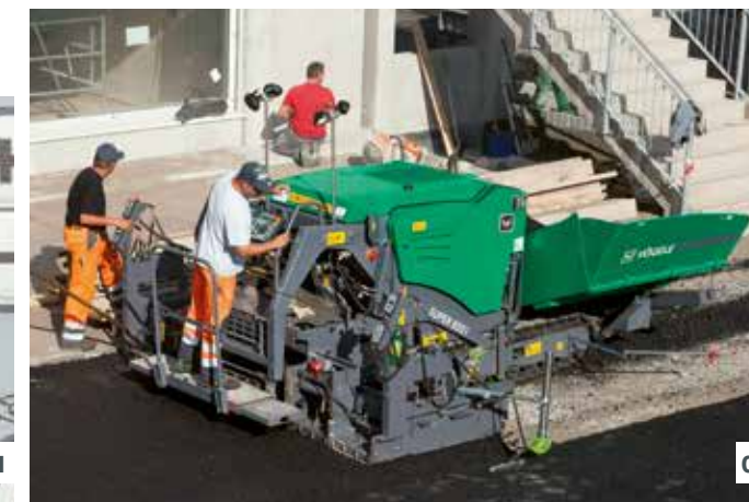
01 Нажатием кнопки укладчик переключается в режимы работы «Укладка», «Позиционирование», «Маневрирование», «Нейтральный». 02 Для лёгкого и точного маневрирования машина управляется поворотной ручкой.
